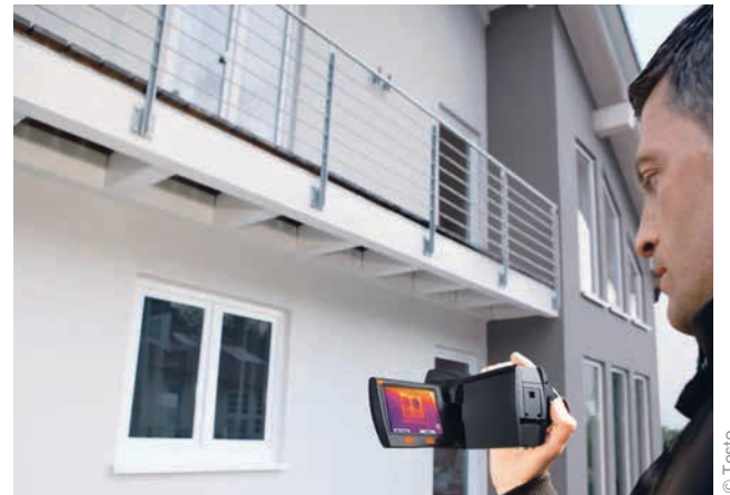
1 | Einsetzbar sind Wärmebildkameras u. a. bei der Bauüberwachung, Baudokumentation, Mängelerfassung, Qualitätssicherung, Schadensanalyse oder bei der Erstellung von Gutachten.
